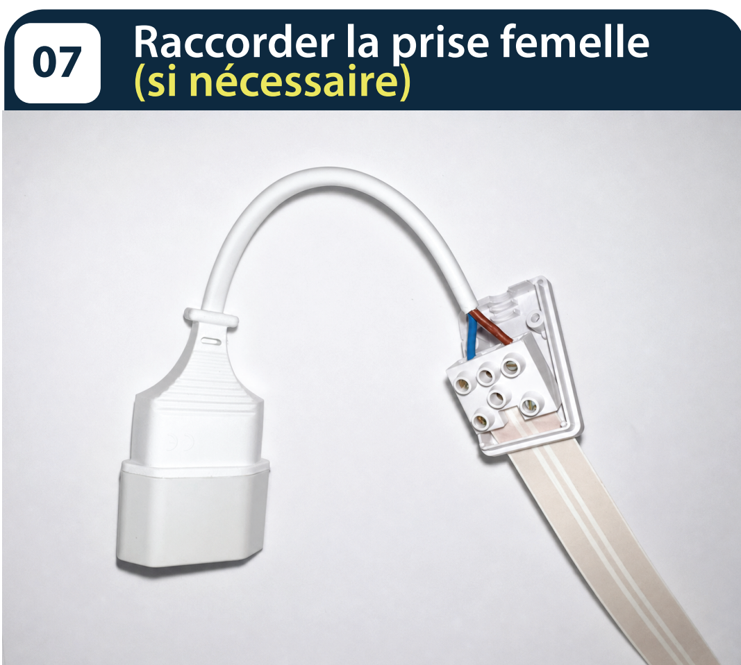
Insérer les fils phase et neutre (et terre pour les prises 3 lignes). Resserrez les vis sans endommager les conducteurs.
